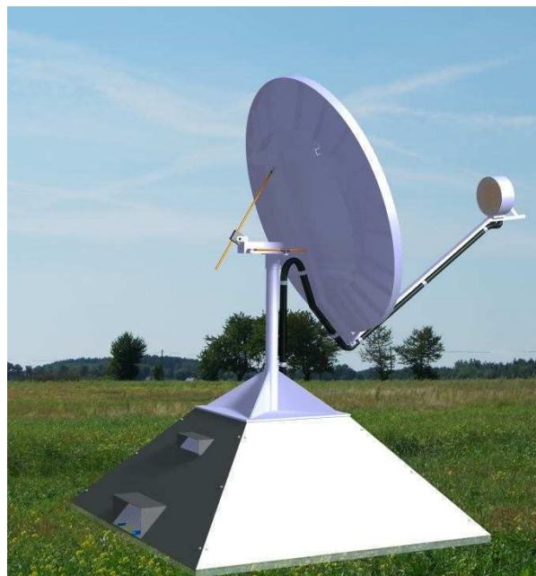
Figura 3. Diseño de concentrador parabólico con calentador en foco
