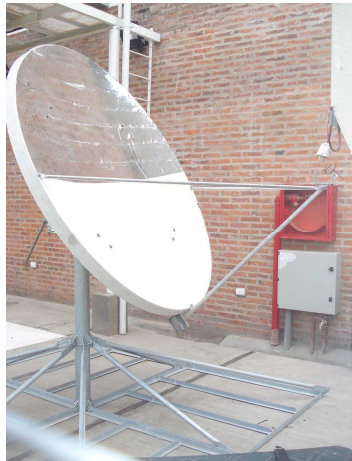
Figura 1 Estructura inicial del concentrador parabólico.
