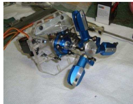
Figura 4. (Izquierda) Detalle del montaje de los servos en el equipo. (Derecha) Detalle del rotor modificado para trabajar con 3 palas.
