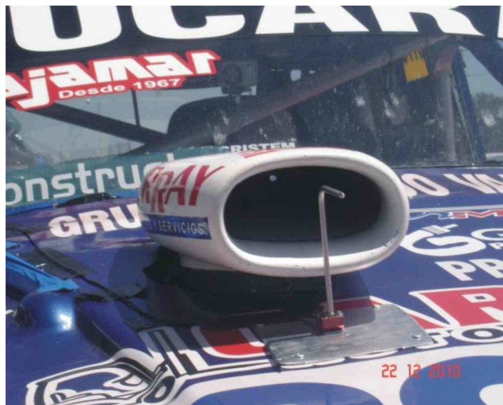
Figura 1 Posición del tubo Pitot sobre le auto de Lionel Ugalde
