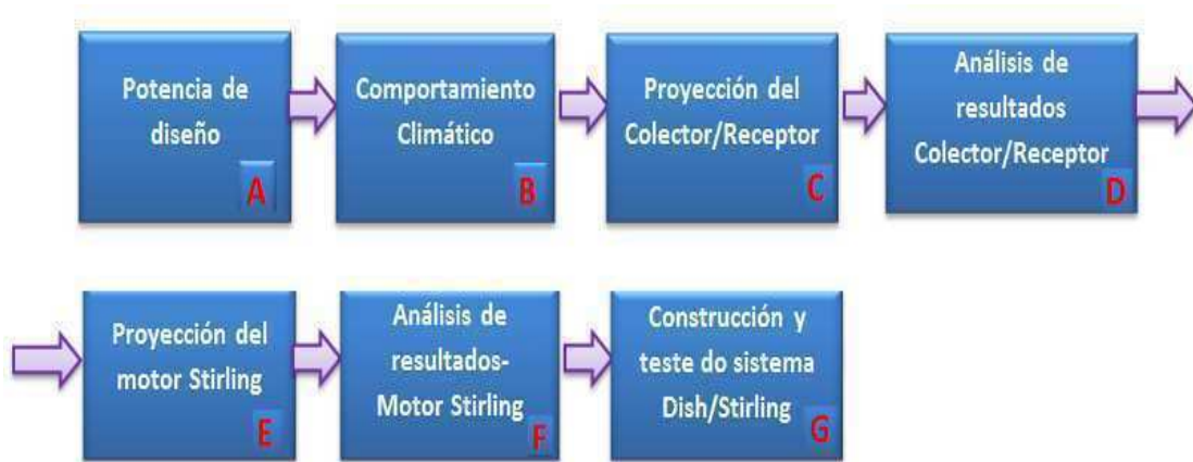
Figura 1. Metodología de cálculo para sistemas Dish/Stirling
