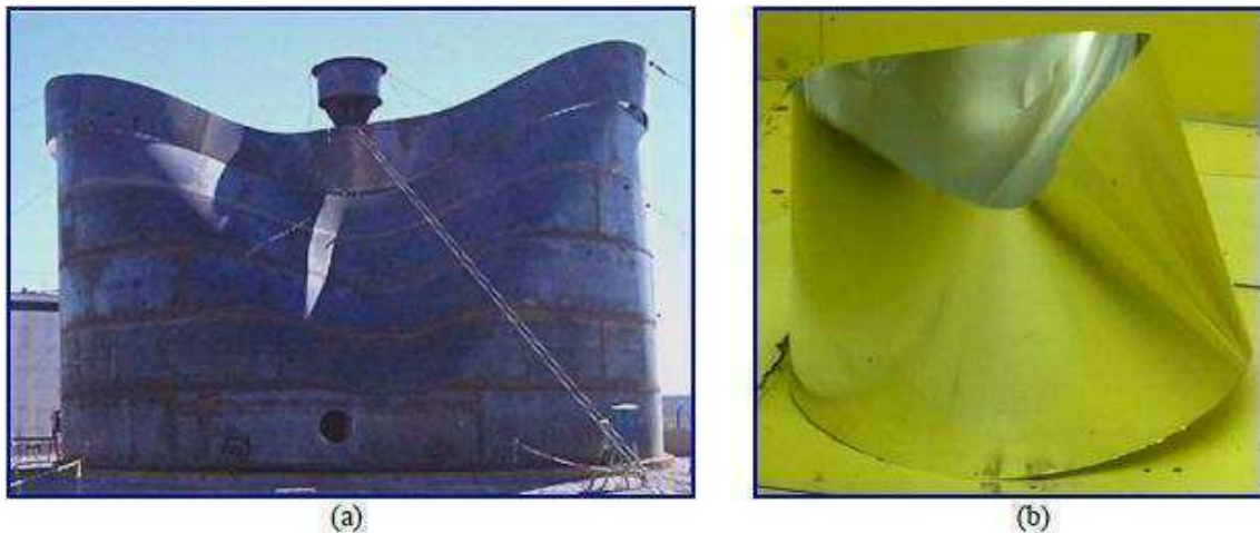
Figura 11: Comparación entre: (a) el tanque real tipo A colapsado, y (b) la deformación lograda en el ensayo en el túnel de viento.
