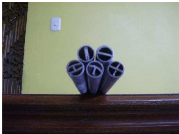
Figura 2. Fotografía de los tubos con aletas internas en forma de rejilla
