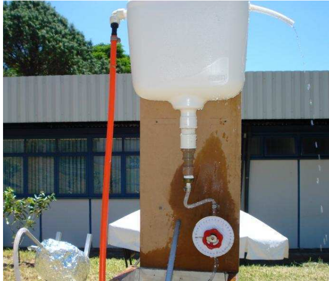
Figura 2 Caixa de estabilização de pressão e válvula de controle de vazão.
