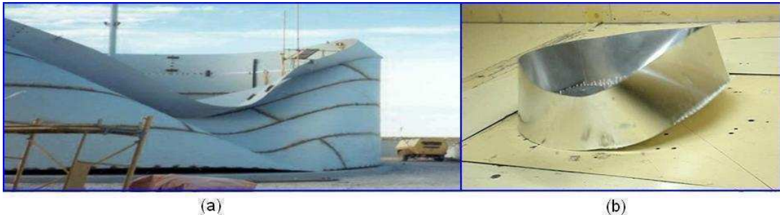
Figura 11: Comparación entre: (a) el tanque real tipo A colapsado, y (b) la deformación lograda en el ensayo en el túnel de viento.
