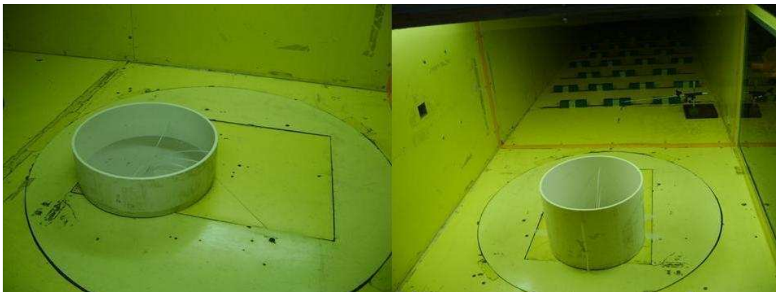
Figura 3: Dos modelos de tanques ensayados para medir la presión estática sobre las paredes externas, internas y en el fondo.
