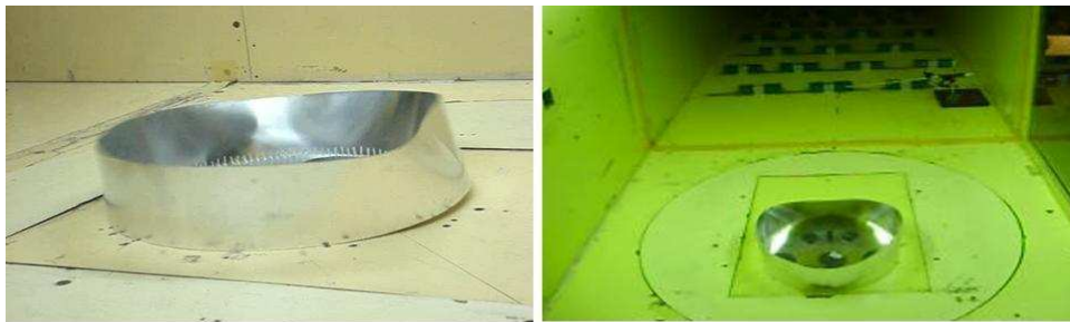
Deformación de ambos tanques debido al viento y el efecto del vórtice interno
