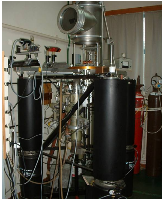
Figura 21. Péndulo de torsión sub-resonante del Centro Atómico Bariloche.
