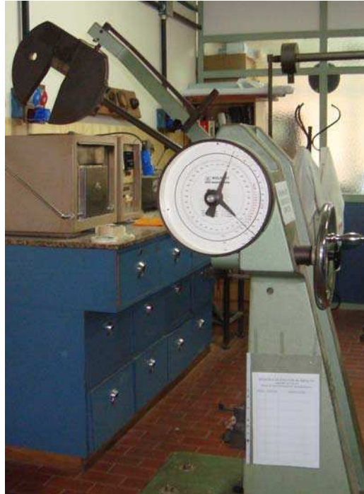
Figura 3 Máquina de Ensayos de Impacto, Método Charpy.
