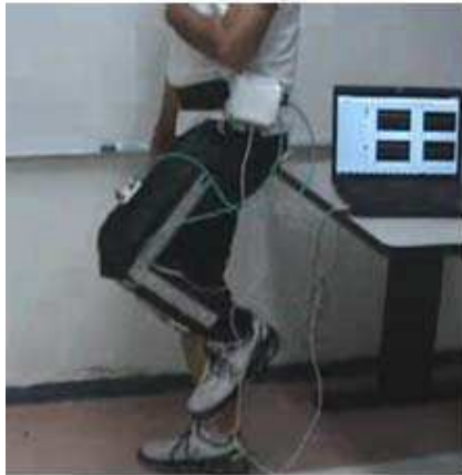
Figura 5 Electro goniómetro, acelerómetros y Alineación de prótesis de rodilla libre [9]
