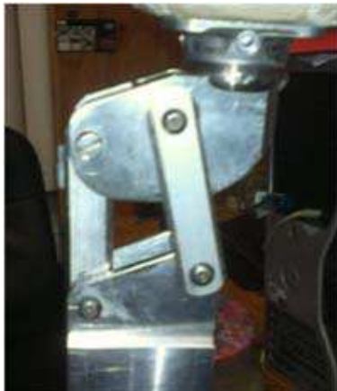
Figura 6 Alineación de la prótesis de mecanismo de 4 barras [9]
