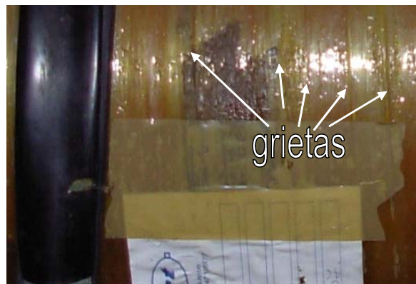
Figura 5: Grietas observadas en cilindros de GNC Tipo 2, montado en un vehículo
