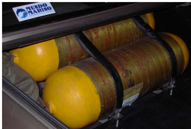
Figura 3: Cilindros de GNC Tipo 2 (acero PRFV) montados en un vehículo.
