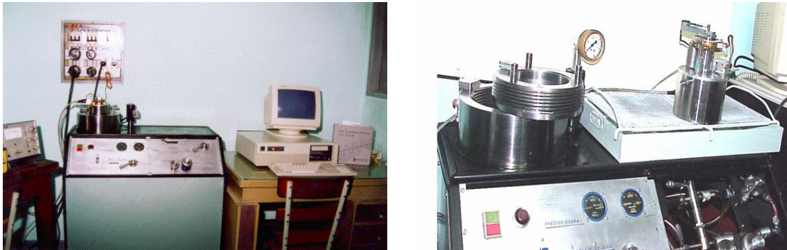
Figura 2 Equipo hidráulico de expansión biaxial
