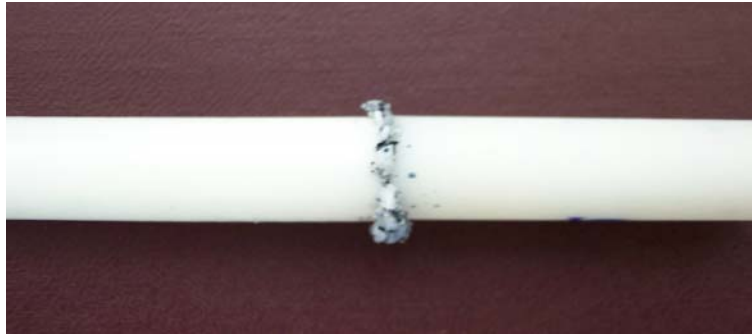
Figura 3: Conjunto de dos muestras de PEAD unidas por soldadura
