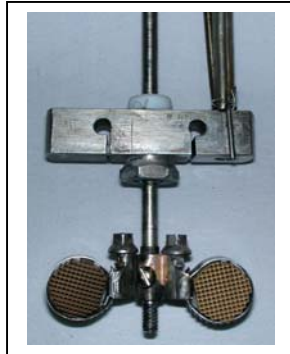
Figura 2 Detalle del soporte que acopla los agitadores monolíticos al eje del agitador.
