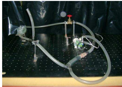
Figura 2 Circuito hidráulico montado sobre la mesa óptica
