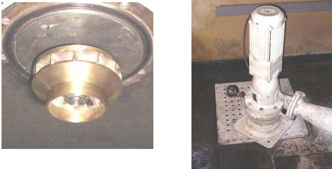
Figura 6 a) Rodete ensamblado b) Máquina hidráulica instalada y operando.
