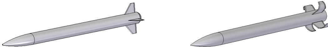
Figura 5. Configuraciones simplificadas para Missile DATCOM y PAN AIR
