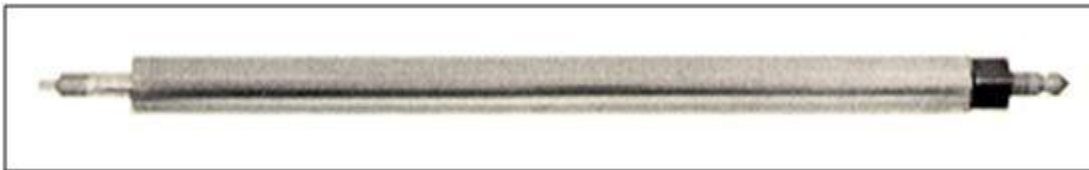
Figura 1- Elemento Combustível revestido em alumínio do reator TRIGA IPR-R1 [1].
