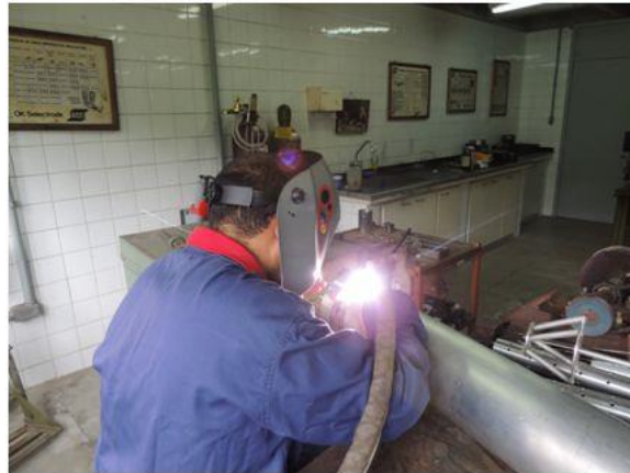
Figura 7- Oficina de soldagem e tanque de sipping após soldagem
