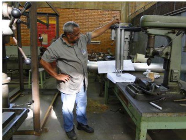
Figura 6. Cesta de carregamento do aparelho de sipping em tamanho normal, sobre bancada da oficina mecânica.
