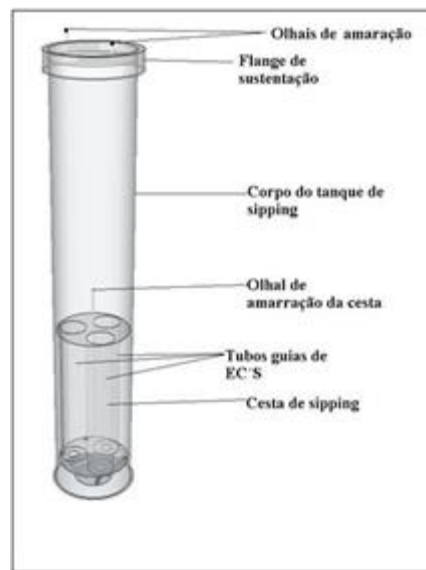
Figura 2. Dispositivo de sipping em imagem simplificada
