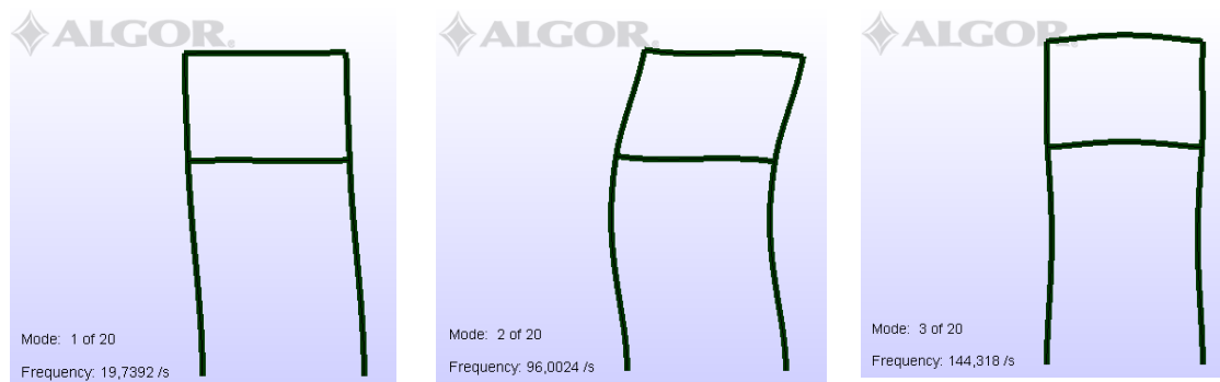
Figura 4: Primeras 3 formas modales del pórtico empotrado -empotrado, obtenidas utilizando 10 elementos por barra en el Software Algor [6].
