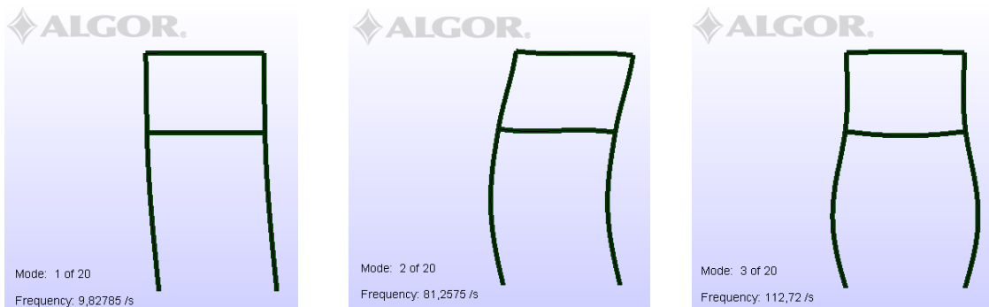
Figura 3: Primeras 3 formas modales del pórtico biarticulado, obtenidas utilizando 10 elementos por barra en el Software Algor [6].
