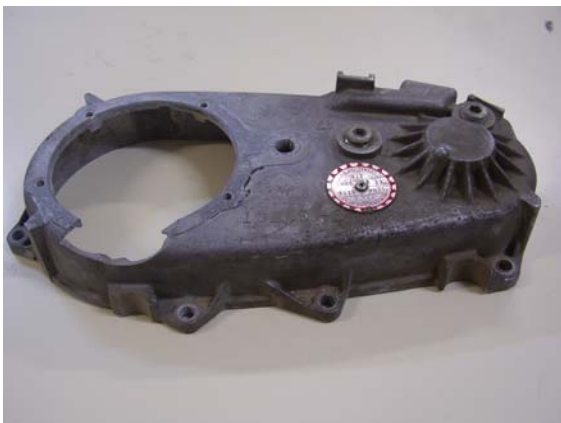
Figura 1. Tapa de la caja de transferencia dañada.
