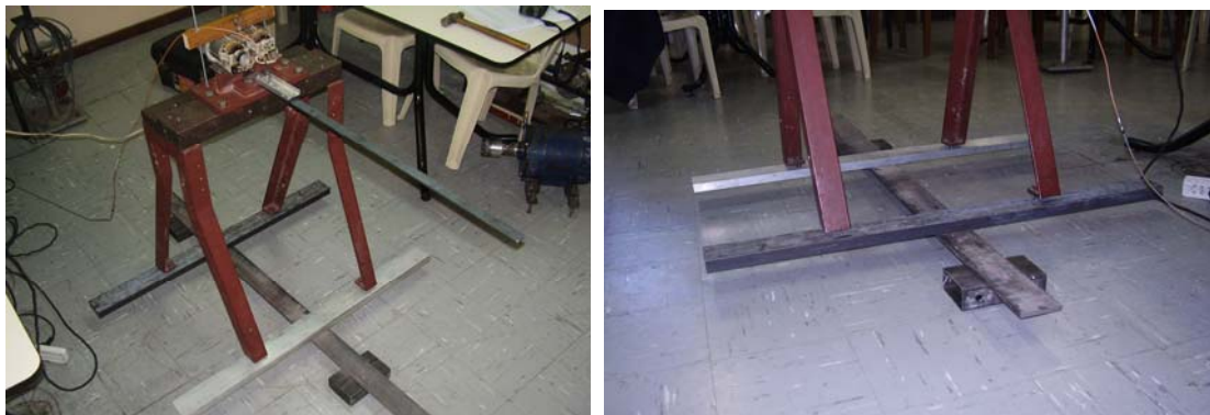
Figura 3 Estructura de soporte para el ensayo dinámico con excitación armónica.
