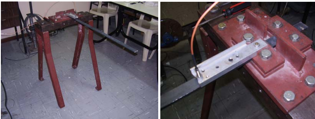
Figura1 Montaje de la viga (izquierda) y detalle del empotramiento y sensor (derecha).
