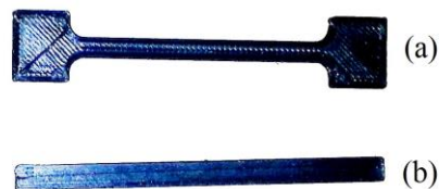
Figura 1. Ejemplo de probetas. (a) Para tracción, (b) Para flexión.
