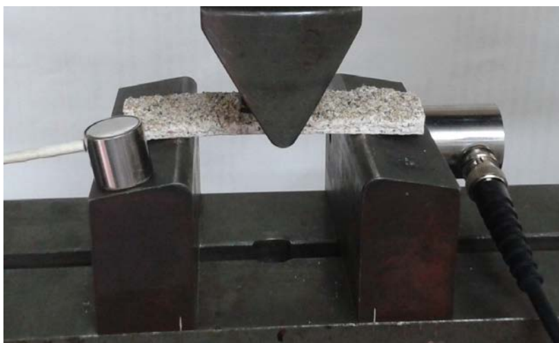
Figura 3. Ensayo de flexión en 3 puntos de una cáscara cerámica
