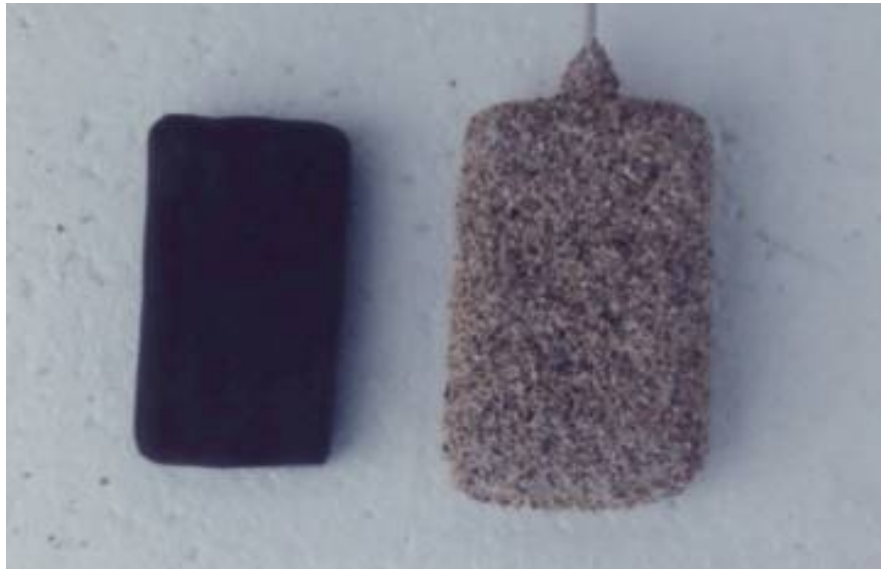
Figura 2. Modelo de cera (izquierda) sobre el cual se moldeó la cáscara cerámica (derecha)
