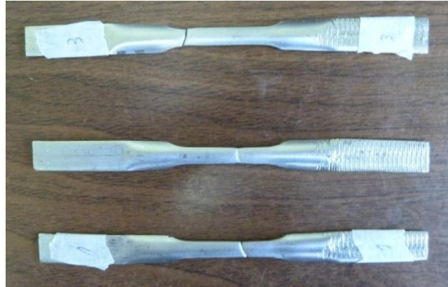
Figura 5. Zona de falla en las probetas \frac{1}{4} de tubo ensayadas a tracción.
