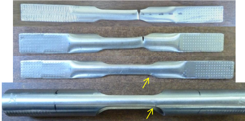
Figura 8. Probetas ensayadas a fatiga uniaxial con fisura en la región de transición con la mordaza.
