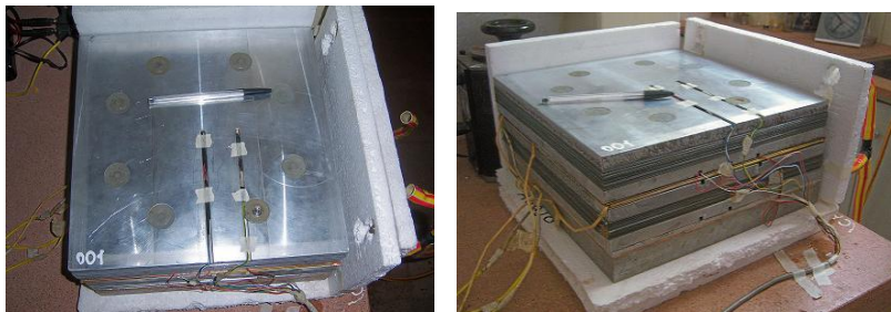
Figura 7 y 8: muestras de bobinas estáticas preparadas para su ensayo
