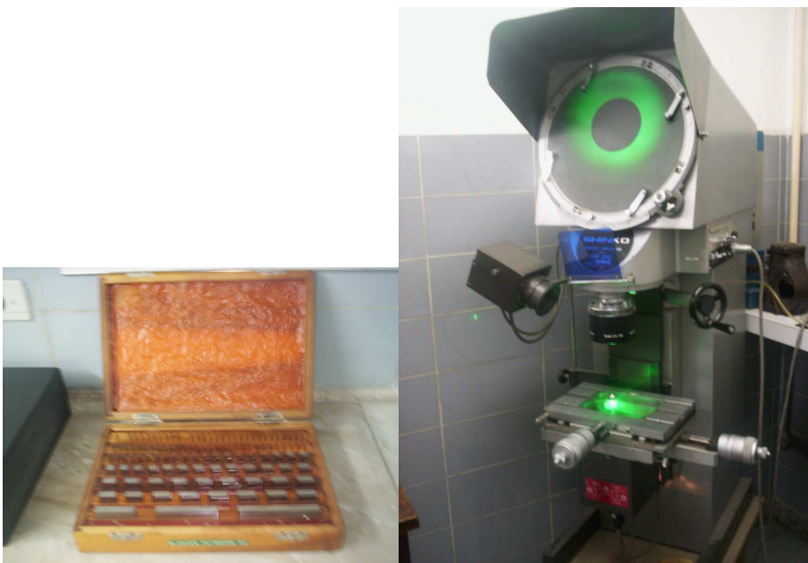
Figura 1 Proyector de perfiles utilizado y caja de bloques patrón de referencia
