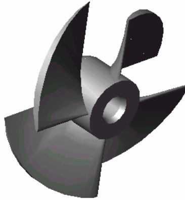
Figura 1: Vista en perspectiva del rodete utilizado.
