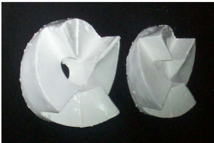
Figura 2: Herramental utilizado para el proceso de sujeción durante la soldadura.
