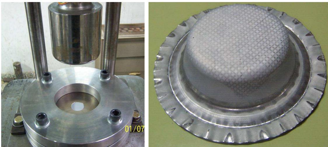
Figura 4 Matriz Marciniak y producto de ensayo
