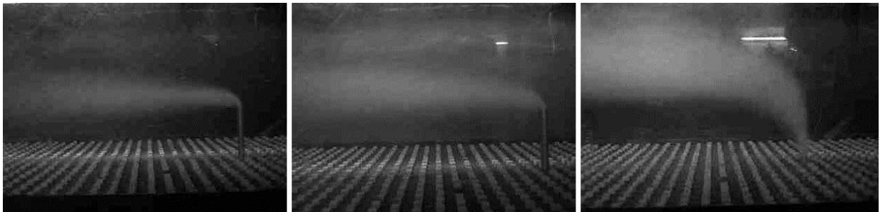
Figura 2. Pluma de dispersión en la cámara del túnel de viento, correspondiente a Re= 5,7 \times 10^5 , Re= 3,1 \times 10^5 , Re= 5,8 \times 10^4 .
