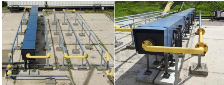
Figura 1 Fotografia dos trechos retos da linha de parafinação a direita e detalhe do tubo amostra a esquerda
