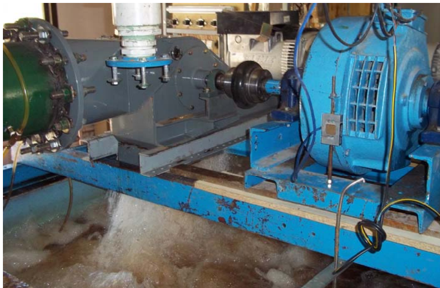
Figura 4: Elementos montados sobre el banco hidráulico, a la izquierda dinamómetro.
