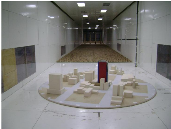
Fig. 3. Modelo del edificio en la cámara de ensayos del túnel de viento y ejes de referencia adoptados e indicación de ángulo (dirección viento incidente).
