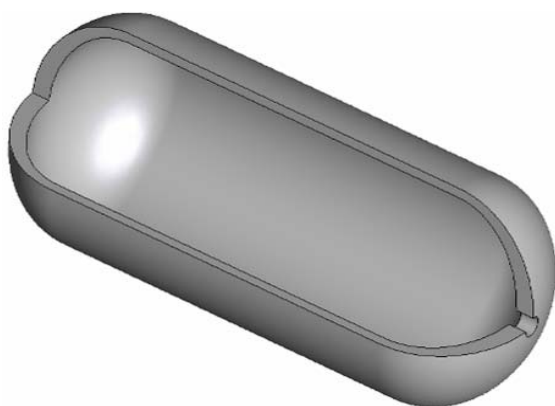
Diámetro: 0,355 m. Longitud: 0,85 m. Espesor en la parte cilíndrica 0,016 m.
