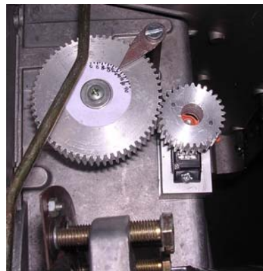
Figura2a y 2b. Servo motor GWS modelo Mirco-2BBM Sistema de control del damper de aire en los quemador
