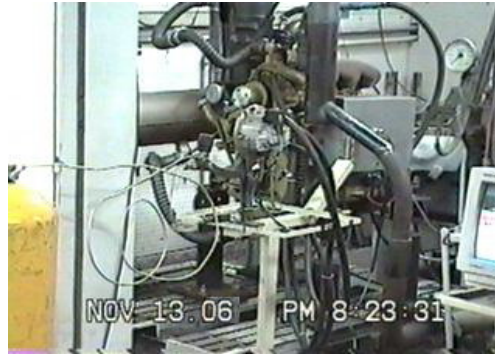
Figura 1 Motor John Deere montado y adaptado para funcionamiento dual en banco de ensayos.
