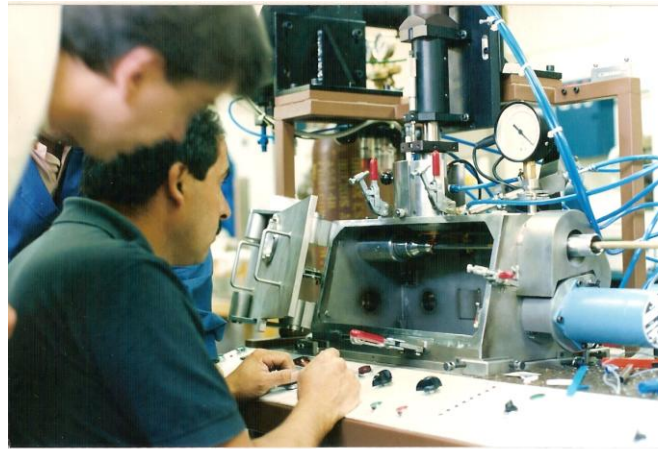
Una cámara de soldadura de aplicación del proceso Láser.
