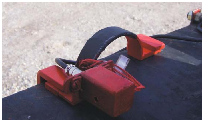
Figura 5: Fotografía de la primer celda ensayada, montada sobre una viga.
