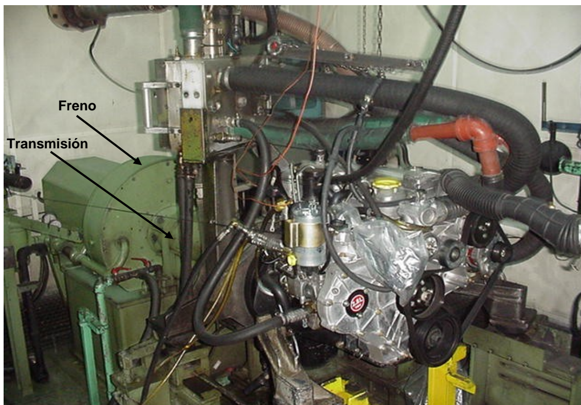
Figura 1 Vista de un motor en ensayo, transmisión cardánica (protegida), freno dinamométrico, circuitos auxiliares de refrigeración, conductos de aire y escape
