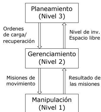
Figura 5: Estructura y flujo de información del sistema de administración y control
