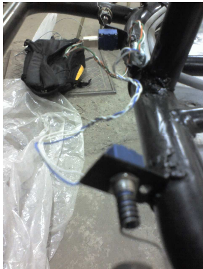
Figuras 4a y 4b: Acoplamiento de potenciómetros de precisión en pedales.
