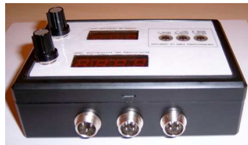
Figura 8: Vista del contenedor del sistema de prueba. Se observa la interfaz con el usuario e instrucciones básicas de conexión.
