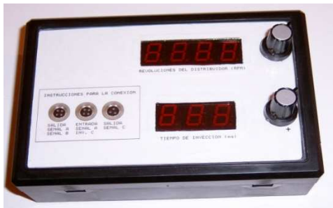
Figura 8: Vista del contenedor del sistema de prueba. Se observa la interfaz con el usuario e instrucciones básicas de conexión.
