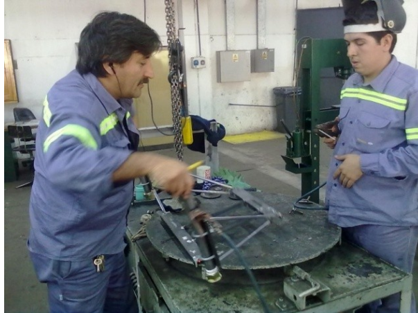
Figura 8. Proceso de armado de la estructura soldada del simulador
