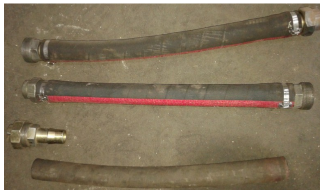
Figura 3. Muestras de mangas, su acople y zuncho extremos.
