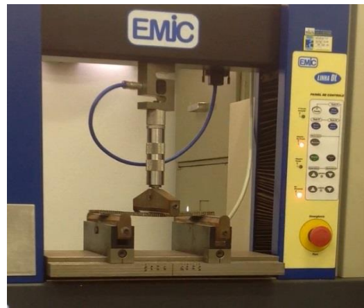
Figura 3: a) Honeycomb com face de fibra de carbono e b) Ensaio em três pontos
