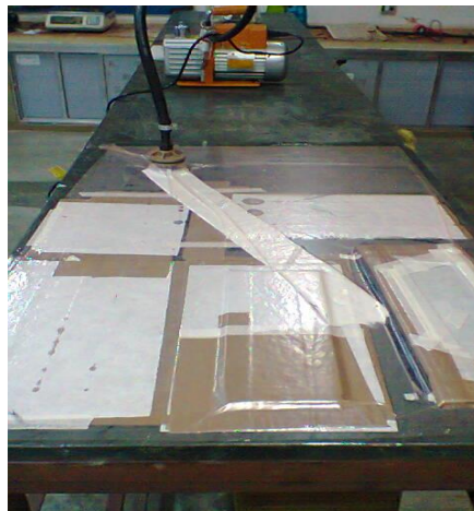
Figura 5: Aplicação do vácuo na fabricação das placas
