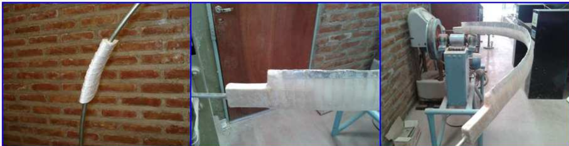
Figura 2: Fotografía que muestran el proceso de fabricación artesanal de las aspas en PRFV.
