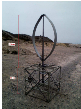
Figura 1: Fotografía del modelo de Darrieus que se construyó para realizar ensayos dentro de un túnel de viento.
