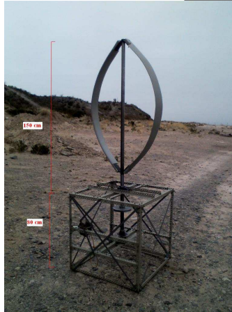
Figura 8: Darrieus montado en la estructura soporte.
