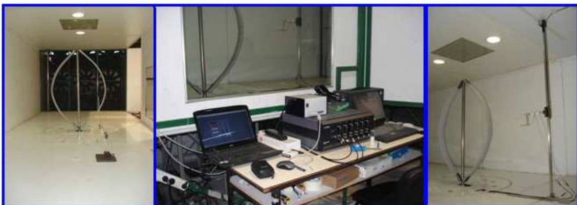
Figura 9: ubicación de la turbina Darrieus dentro del túnel de viento y el equipamiento utilizado.
