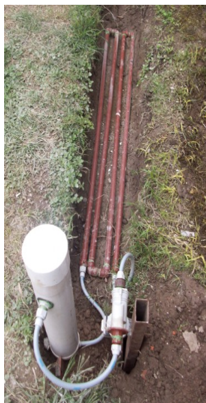
Figura 2. Vista del sistema calefactor y digestor anaeróbico.
