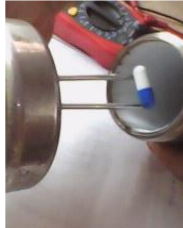
Foto 6: Colocación de la cápsula en la bomba
