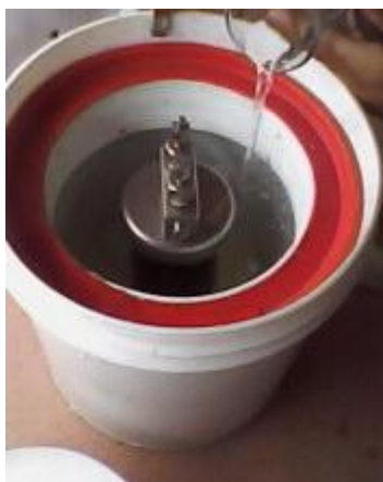
Foto 7: Inmersión de la bomba en agua destilada
