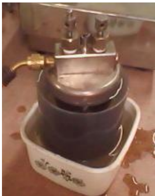
Foto 1: Vista exterior de la bomba calorimétrica
