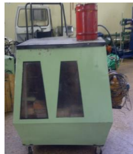
Figura 2 Caldera pirotubular vertical (Izq) - banco de pruebas de combustión (Der)
