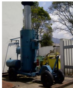
Figura 2 Caldera pirotubular vertical (Izq) - banco de pruebas de combustión (Der)
