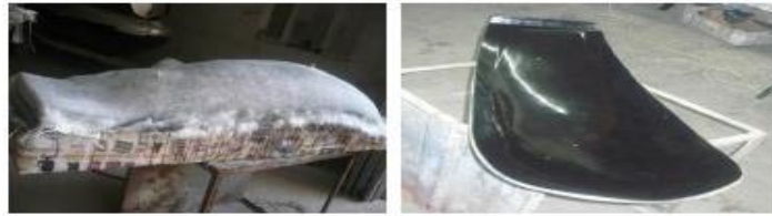
Figura 5. Obtención del molde listo para la elaboración de cada aspa.
