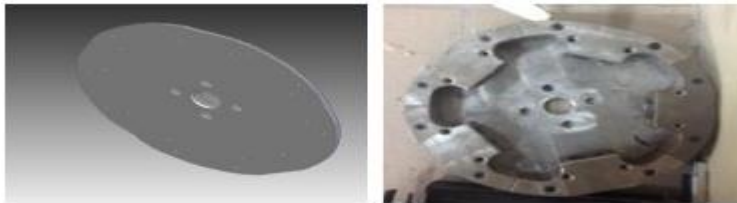
Figura 10. Base de la turbina y acabado de la pieza completa
