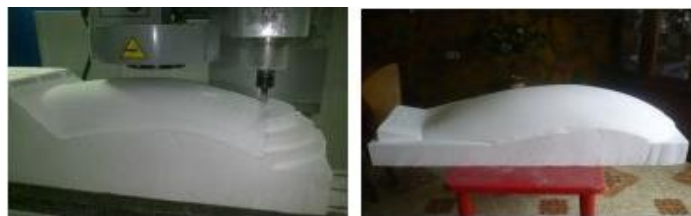
Figura 3. Fabricación del molde
