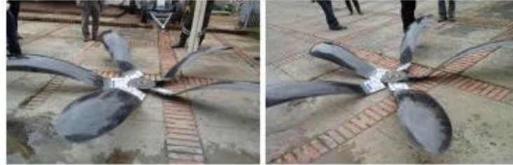
Figura 11. Ensamble de las 5 aspas bioinspiradas
