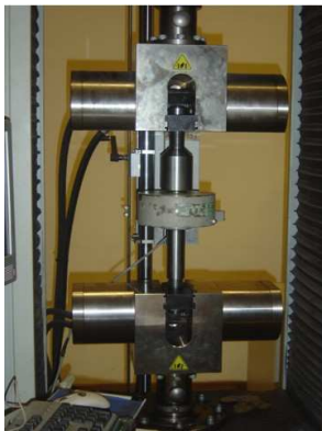
Figura 1 Ejemplo de dispositivos para tracción con amarres según norma ISO-376.
