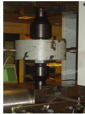
Figura 3 Ejemplo de dispositivos utilizados para tracción con amarres según norma ISO-376 para celda de 500 kN en máquina de ensayos de 600 kN.
