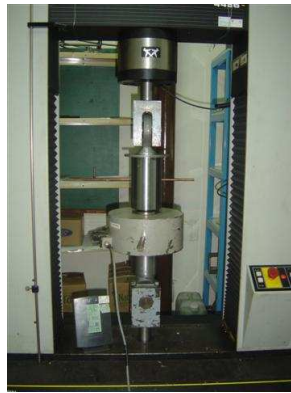
Figura 2 Máquina universal para ensayos con transductor de fuerza de 300 kN.
