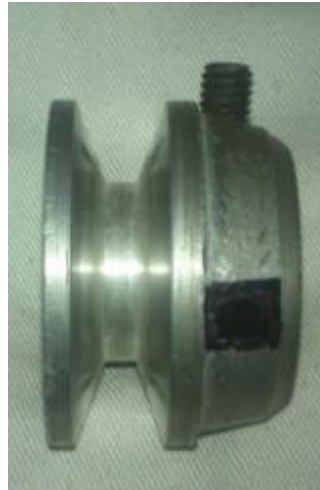
Figura 2: Polea torneada y con prisionero para poder acoplarla al eje del generador eléctrico.
