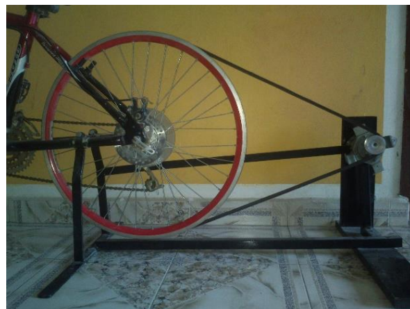
Figura 4: Base de hierro con la bicicleta ajustada, el generador eléctrico ajustado y la correa tensionada.
