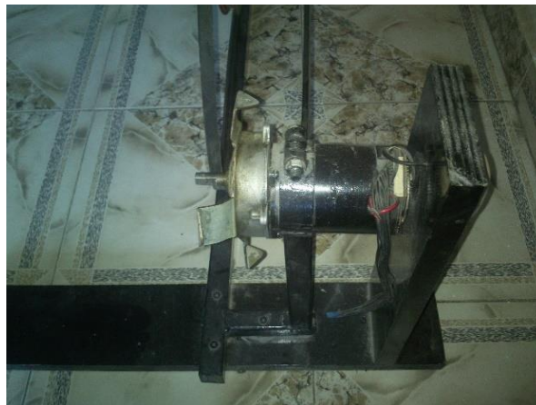
Figura 3: Generador eléctrico asegurado a la base de hierro.
