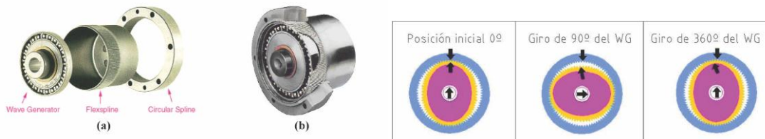
Figura N°5 . (a) Despiece del HD (b) Ensamblaje de HD típico (c) modo de operación.
