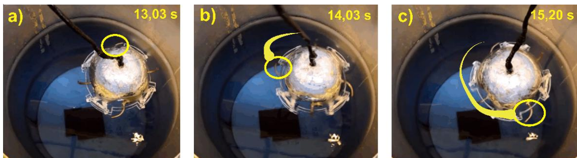
Figura 15 Imágenes del movimiento de Yaw. Se indica con una estela amarilla el recorrido aproximado de la salida de una de las bombas.
