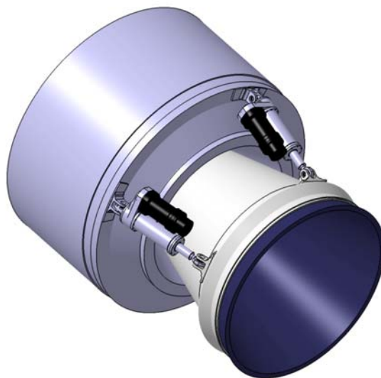
Fig. 4. Montaje preliminar de los actuadores.
