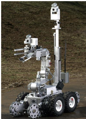
(a) EOD AndrosF6A de Remotec.
