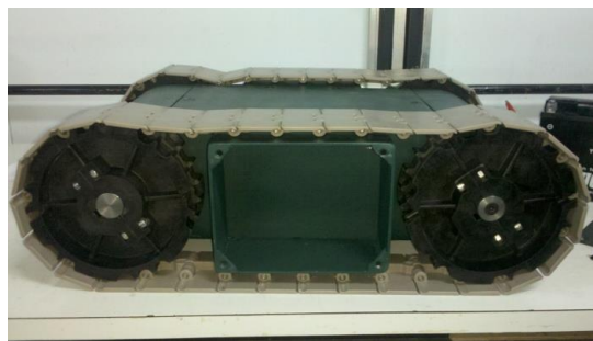
Figura 5: Alojamiento de baterías
