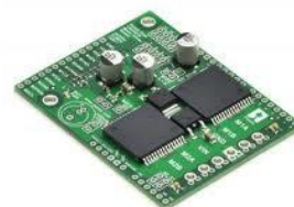
(b) Placa control de motores
