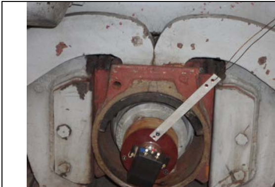
Figura 10. Segundo prototipo instalado en la rueda de la locomotora.
