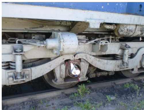
Figura 15. Tercer prototipo colocado en la rueda de la locomotora.
