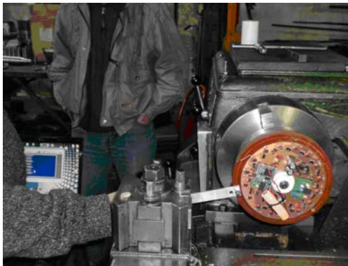
Figura 4. El sistema colocado en un torno para simular el giro de la rueda, la PC receptora de la comunicación con los datos relevados.
